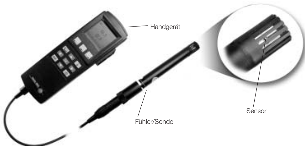
Abb. 1: Bestandteile eines Messgeräts
