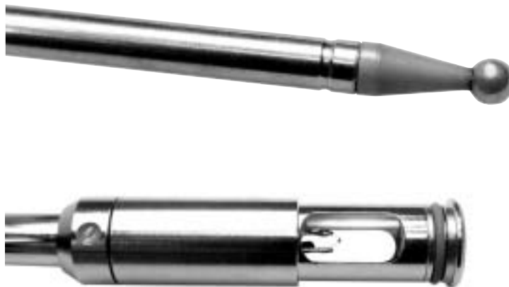
Abb.23: Hitzkugel- und Hitzdrahtbauweise
