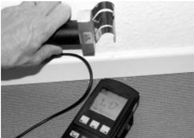
Abb. 10: Handhaltung einer Schleifenkopfsonde
