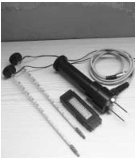
Abb. 12: Sondentypen für Leitfähigkeitsmessung
