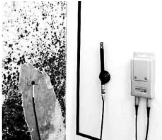
Abb. 30: Befestigung eines Plättchenfühlers
