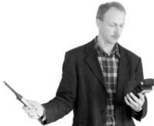
Abb. 2: richtige Handhaltung bei Messung von Lufttemperatur und Luftfeuchte
